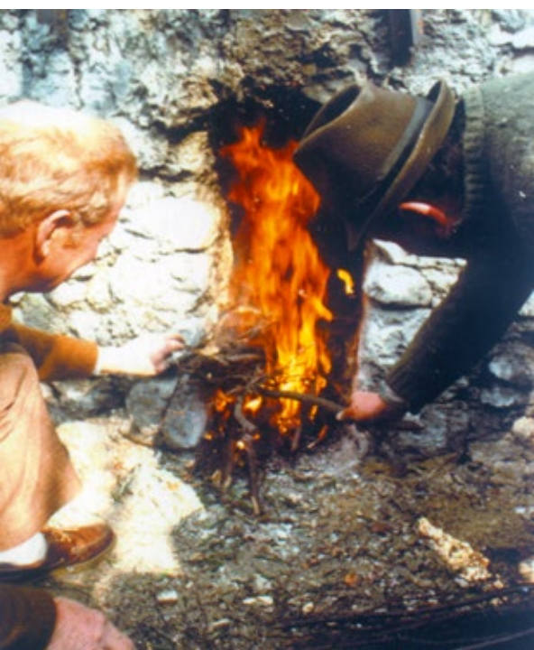
Accensione del fuoco nella calcara, e fornello in funzione.
