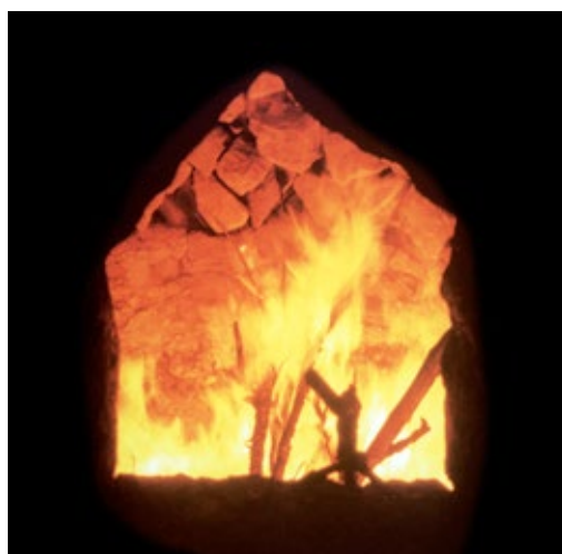
Accensione del fuoco nella calcara, e fornello in funzione.
